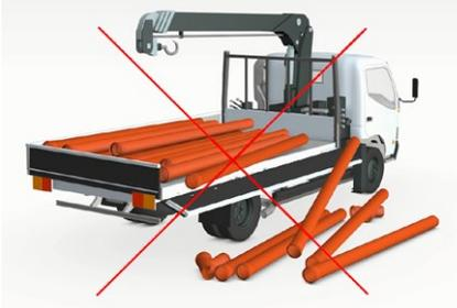
Bei unsachgemäßem Transport oder falscher Lagerung können Verformungen oder Beschädigungen von Rohren auftreten, die zu Schwierigkeiten bei der Verlegung und zur Beeinträchtigung der Funktionssicherheit der verlegten Leitung führen können.
