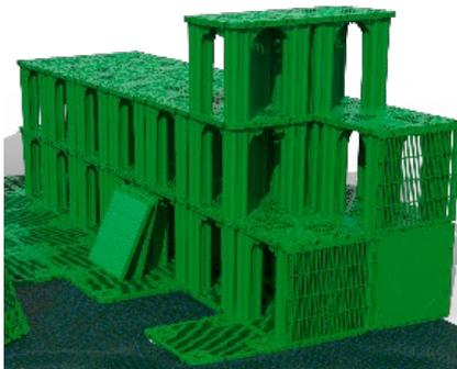
Achten Sie besonders darauf, dass alle STORMBOX-Elemente exakt übereinander stehen und richtig miteinander verbunden sind. Überstände sind in keiner Richtung erlaubt! Damit ist gewährleistet, dass alle auftretenden Kräfte über die Verstärkungssäulen aufgenommen und abgeleitet werden können.
