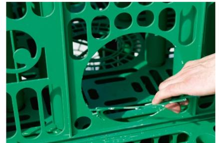
Wird eine Kamerabefahrbarkeit und/oder Spülbarkeit des Systems gefordert, so schneiden Sie die dafür vorgesehenen Kanäle in den Elementen vor Einbau aus. Eine nachträgliche Entfernung des vorgestanzt Rasters ist nicht möglich.
