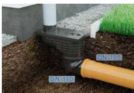
5. Kanalrohr anschließen DN110 - direkt DN125 - ablängen!
