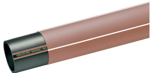
PE KANAL RC ROBUST ist die Weiterentwicklung unseres seit Jahren am Markt bewährten Robust Pipe in Verbindung mit den hervorragenden Eigenschaften von PE 100-RC. So entstand eine besonders widerstandsfähige Kombination aus dem **PE KANAL RC-Rohr und einem abschälbaren Schutzmantel aus mineralstoffverstärktem Polypropylen.**
