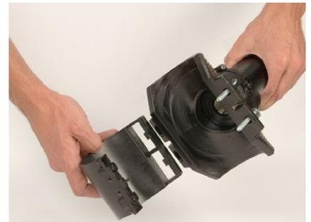
Setzen Sie die Schelle auf das Rohr und ziehen Sie die Schrauben mit Außensechskantschlüssel (SW8) wechselseitig und gleichmäßig an.
