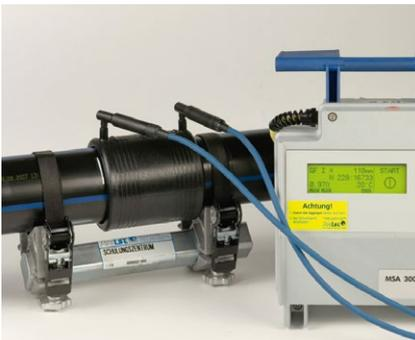
Bringen Sie die Schweißkabel mit den passenden Adaptersteckern gewichtsentlastet an den beiden Anschlusssteckern des ELGEF Plus Fittings an. Geben Sie nach Anschluss des Schweißgerätes an die Stromquelle und Einschalten des Hauptschalters die Schweißdaten mittels Strichcode ein.
