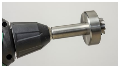
unzulässig eingespannter ROB-BOHRER
