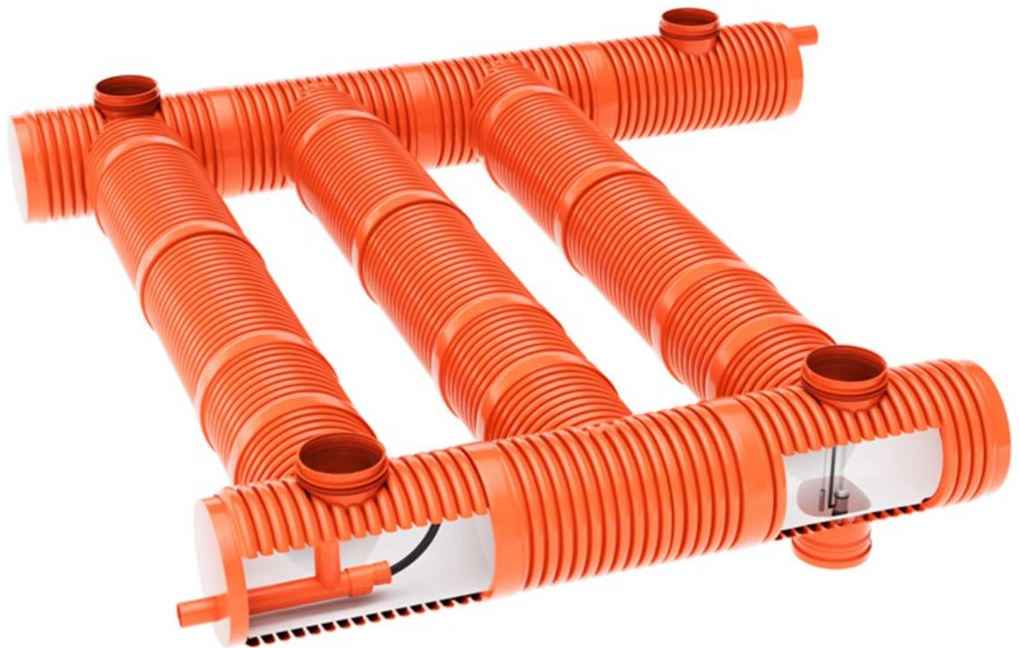
Dank des flexiblen Baukastensystems und einer großen Auswahl an Formstücken lassen sich die Stauraumkanäle an jede Projektgröße anpassen und auch bei schwierigen Einbausituationen realisieren. Die Rohre sind in mehreren Steifigkeitsklassen (SN8, SN12, SN16) verfügbar und ermöglichen eine Installation unter schwerlastbefahrbaren Flächen, was sie ideal für städtische und industrielle Einsatzorte macht.
