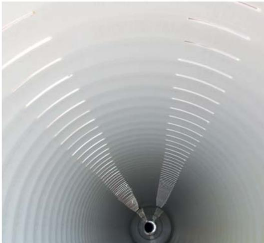
**Besonders hervorzuheben ist bei allen Ausführungen der große Eintrittsquerschnitt mit mindestens 100 cm<sup>2</sup> pro Meter.** Wie das ungeschlitzte Großrohr besitzt auch das PP-Dränage-Großrohr die Steifigkeitsklasse SN8 und ermöglicht damit eine Verlegung bei geringer Überdeckung bzw. bei hohen Verkehrslasten.
