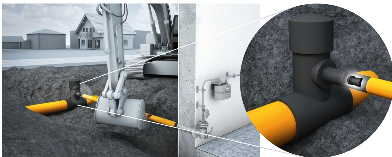
Fig. 1: Daños por excavadora en tubería de acometida (TA)
