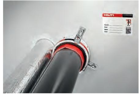
**Beschreibung:** Die Brandschutzmanschette CFS-C EL auf beliebigem Rohrtyp der Rohrgruppe 1 kann in direktem Kontakt zu Conlit 150 und Rockwool 800 als Wärmeisolierung auf Metallrohren installiert werden ( $s_1 \geq 0 \text{ mm}$ ).
