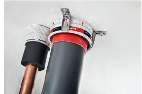
**Beschreibung:** Die Brandschutzmanschette CFS-C EL auf beliebigem Rohrtyp der Rohrgruppe 1 kann in direktem Kontakt zu Metallrohren mit einer Isolierung aus flexiblem Elastomerschaum und Abschottung mit der Hilti Brandschutzbandage CFS-B installiert werden ( $S_1 \geq 0 \text{ mm}$ ). Die Verwendung der Hilti Brandschutzbandage CFS-B ist detailliert in der ETA -10/0212 beschrieben.
