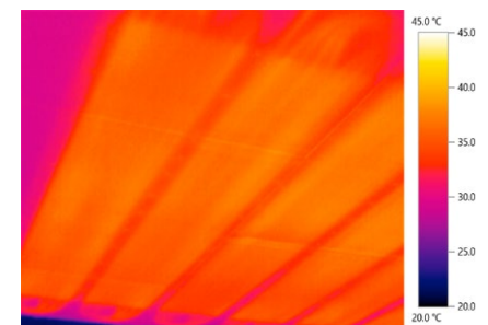
Abb. 2: Temperaturverteilung an der Unterseite der abgehängten Decke mit CDP400 Paneelen
