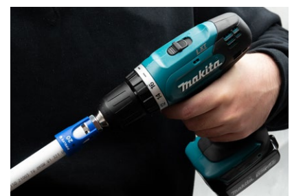
Abbildung 10: Kalibrierung mittels Bohrmaschine
