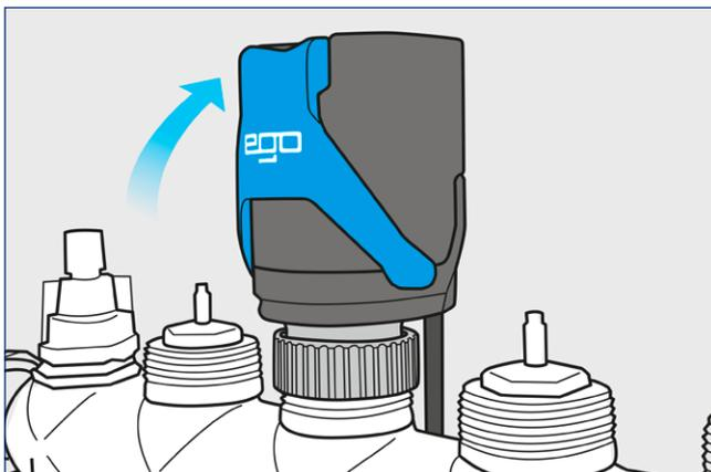
**5** Temperatursensor-Clips befestigen
