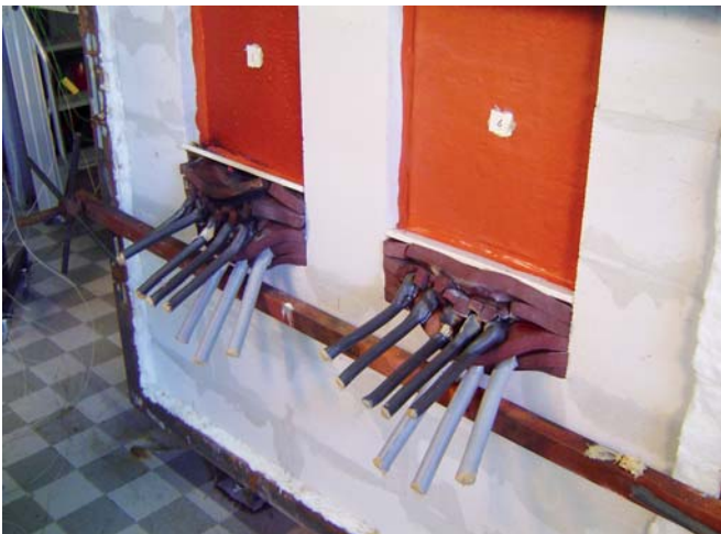
NOFIRNO und ACTIFOAM im Kombischott nach 90 Min. brandabgewandte Seite
