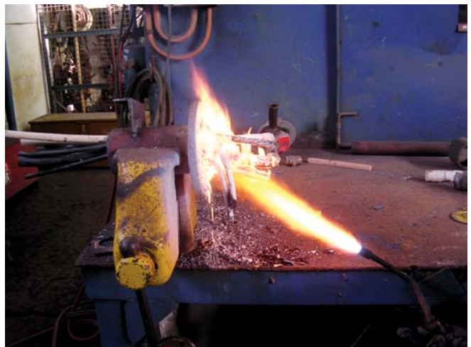
FIWA während der Brandprüfung
