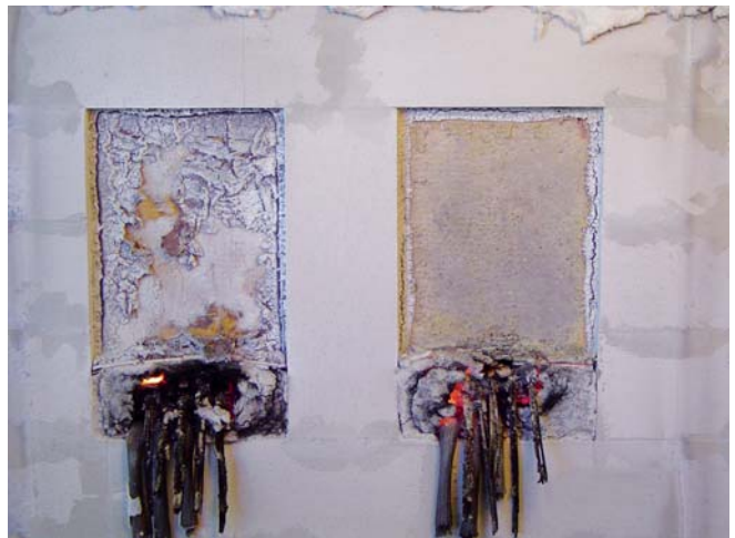
NOFIRNO und ACTIFOAM im Kombischott nach 90 Min. brandzugewandte Seite
