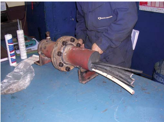
FIWA Prüfaufbau vor Brandprüfung
